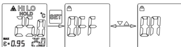
**11. Réglage des alarmes de limite haute et de limite basse**
