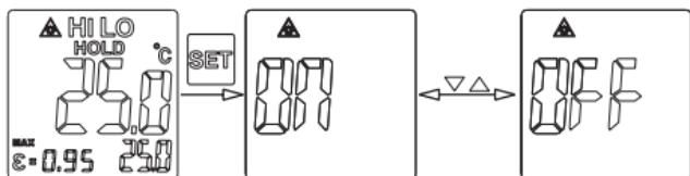
**10. Indstilling af måling uden brug af udløser**
