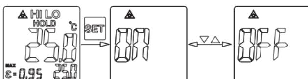
**10. Réglage de la mesure sans déclenchement**
